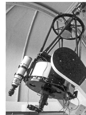
Spiegelteleskop mit 610 mm Durchmesser
