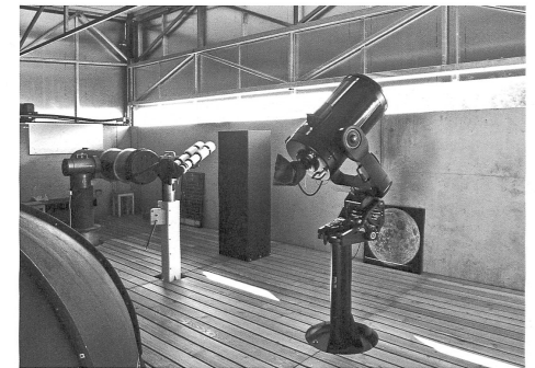
Die beiden Hauptteleskope verfügen über unabhängige Fundamente
