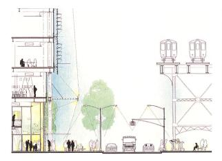
Strassenquerschnitt am Broadway, mit U-Bahn-Viadukt. Mit hinter die Baulinie zurückspringenden, öffentlich genutzten Erdgeschossen sollen die Gebäude des Manhattanville-Campus zu einem belebten Strassenraum beitragen. Bilder: Columbia University
