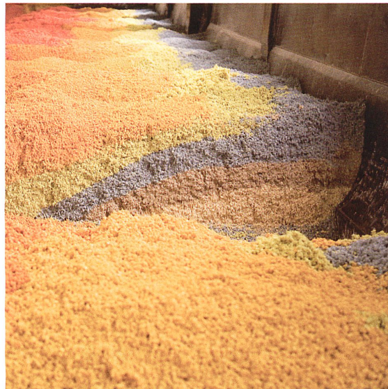
Eingefärbtes Linoleum-Granulat, ein wichtiger Bestandteil der Marmoleum-Rezeptur.
