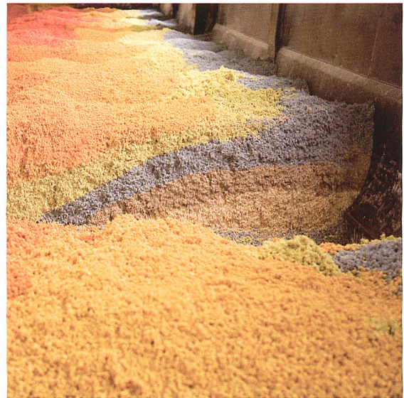
Eingefärbtes Linoleum-Granulat, ein wichtiger Bestandteil der Marmoleum-Rezeptur.
