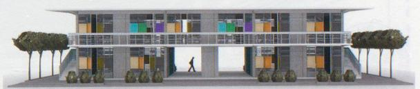
Das Projekt der beiden Hauptgebäude der Schule Berquin in Miragoâne basiert auf der überarbeiteten Version der Bauten in Léogâne und Petit Goâve. Der Kindergarten ist in eingefasstem Mauerwerk geplant. Die standardisierten Pläne mussten für die konkrete Situation einzüglich mit den auf die Bodenbeschaffenheit und das Terrain angepassten Fundamenten ergänzt werden.
