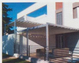
drei neue Produkte. Die Systeme in Holz und Aluminium sind nicht nur als Schattenspender geeignet, sondern schützen auch bei Regen und halten Windböen bis 70km/h stand. Das Regenwasser fliesst über integrierte Regenrinnen ab, auf Wunsch kann eine Beleuchtung integriert werden. Outdooring by Storama
