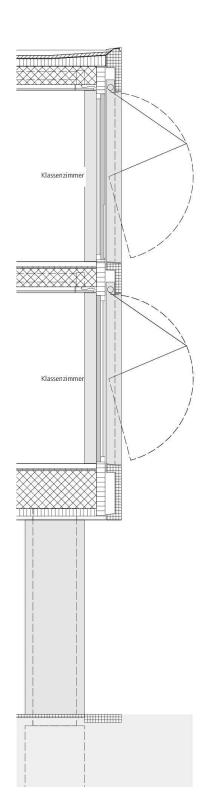
Dachaufbau Extensive Dachbegrünung aus Substrat Schutzbahn Dachhaut bituminös, 2-lagig Dämmung Sopratherm PUR Alu, 14 cm Dampfsperre, bituminös Stahlbetondecke, 34 cm Abgehängte Akustik-Gipsdecke, Knauf, Quadratlochung Anstrich, mineralisch, Keim optil
