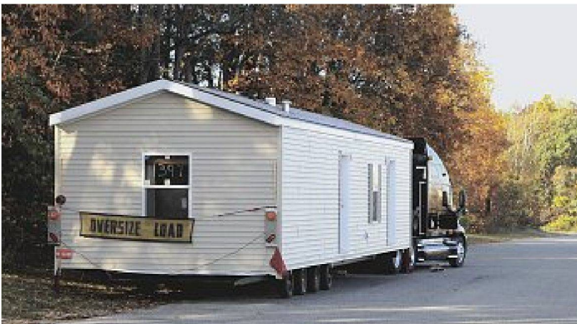
Vorfabrikation und Transport ganzer Häuser in den USA. – Bild: Sacha Menz
