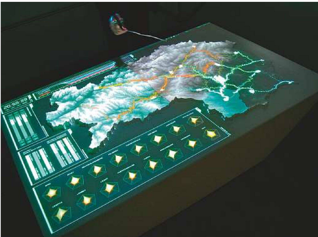
Projekt Atlas Zersiedlung Steiermark: Planungsrelevante Daten unterschiedlichster Herkunft werden auf den Tisch mit dem topografischen Relief der Steiermark projiziert. Die Steuerung der projizierten Daten geschieht mit Hilfe eines Zeigestabes und mit grafischen Elementen, die vom System erkannt und verfolgt werden. Hier dargestellt: Pendlerströme abhängig von Städteprofilen. – Bild: U. Hirschberg
