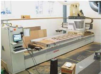
Basierend auf den den digitalen Modellen von designtoproduction werden die gekrümmten Fassadenträger bei Blumer-Lehman in Gossau (oben) und die Eichenbretter bei der Risør Trebåtbyygeri in Norwegen (unten) auf CNC-Maschinen produziert. Am Ende müssen sie auf einen halben Millimeter genau zusammenpassen. Die gekrümmte Geometrie macht ein präzises Einmessen der Verbindungen beim Zusammenbau praktisch unmöglich. Daher ist die Position jedes individuell
