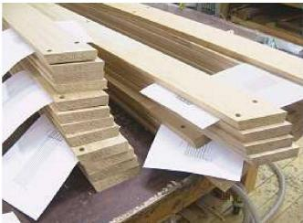
zugeschnittenen Schalbrettes durch Ausfräsungen in den Trägern definiert – der Aufwand wird von der manuellen Montage in die maschinelle Produktion verlagert und damit in die Planung und Arbeitsvorbereitung. Sogar die 125 000 Löcher für die Verschraubung sind im digitalen Modell definiert und werden millimetergenau vorgebohrt. – Bilder: designtoproduction (oben), Risør Trebåtbyygeri (unten)
