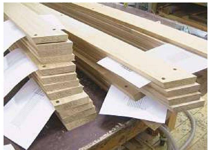
Basierend auf den digitalen Modellen von designtoproduction werden die gekrümmten Fassadenträger bei Blumer-Lehman in Gossau (oben) und die Eichenbretter bei der Risør Trebåtbyggeri in Norwegen (unten) auf CNC-Maschinen produziert. Am Ende müssen sie auf einen halben Millimeter genau zusammenpassen. Die gekrümmte Geometrie macht ein präzises Einmessen der Verbindungen beim Zusammenbau praktisch unmöglich. Daher ist die Position jedes individuell
