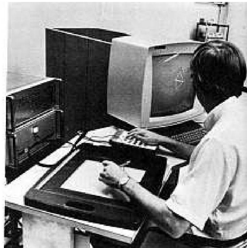
Computer-Aided Design um 1969: Mit dem «light-pen» konnte der Architekt direkt auf dem Bildschirm (links) oder einer interaktiven Oberfläche zeichnen (rechts). Mittlerweile wurde der light-pen durch das «pointing device», der heutigen Computermaus abgelöst. – Bild aus: The Architecture Machine Group, hrsg. von Nicholas Negroponte, Cambridge, Mass. 1970.
