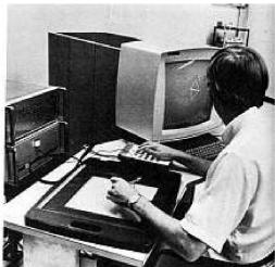
Computer-Aided Design um 1969: Mit dem «light-pen» konnte der Architekt direkt auf dem Bildschirm (links) oder einer interaktiven Oberfläche zeichnen (rechts). Mittlerweile wurde der light-pen durch das «pointing device», der heutigen Computermaus abgelöst. – Bild aus: The Architecture Machine Group, hrsg. von Nicholas Negroponte, Cambridge, Mass. 1970.
