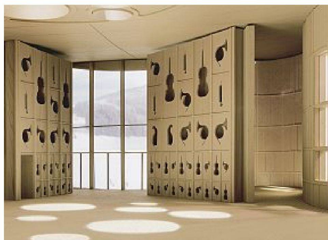
Modell-Innenaufnahmen der siegreichen und zur Weiterbearbeitung empfohlenen «These» von Meili Peter, zusammen mit Andreas Bosshard. Der Raum soll je nach Verwendung bespielt und mittels beweglicher Resonanzkörper gestimmt werden können. Bei geöffneten Resonatoren wendet sich der Raum der Landschaft zu (Bild links).
