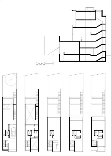
Auf geringer Grundstücksbreite wird die Vertikalität durch die Setzung des Kerns als strukturierendem Element der Geschosse inszeniert.
