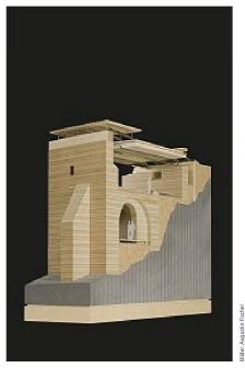
Schnittmodell Revitalisierung Altane Stift Altenburg, Konstruktion der neuen Überdachung.
