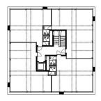
Links nach rechts: Grundstruktur, Unterteilung mit 2 Mietparteien und 2 Nasszellen, 4 Parteien mit 4 separat erschlossenen Nasszellen
