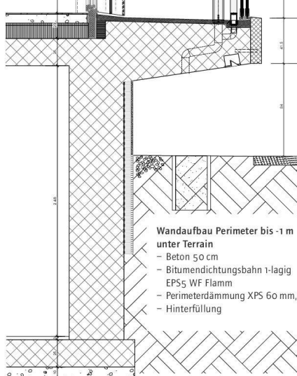
Fassadenschnitt Ostfassade Holz-Fenster, Balkon
