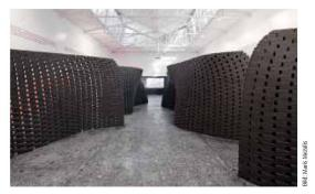
Technology – von der mobilden Roboteranlage R-O-B erstellte Ziegelwand, Professur DFAB, Gramazio & Kohler ETHZ
