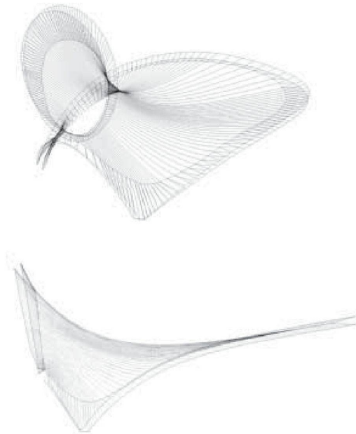
Gesamt- und Seitenansicht des Tubaloon mit eingezeichnetem Membranzuschnitt. Bilder: Snøhetta
