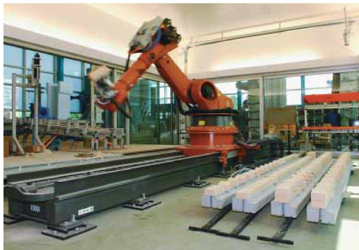
Digitales Kugelmodell zur Genese des Ornaments von Gramazio & Kohler (oben) und Fertigung der Wandelemente durch einen Roboter an der ETH Zürich (unten).
