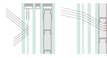
GlassX, eine Neuentwicklung im Grenzbereich von Fenster- und Fassadenbau, die darauf basiert, dass durch die Aggregatsänderung eines Stoffes (früher Paraffin, heute ein Salzhydrat) Energie gespeichert und bei Bedarf (Abkühlung) wieder abgegeben wird (www.qlassx.ch).
