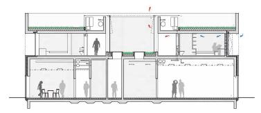
Konstruktionsschnitt durch Wohn- und Arbeitsgeschoss
