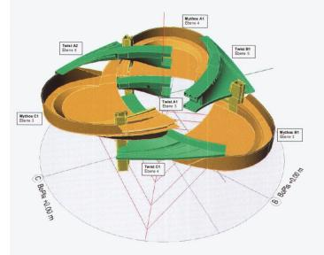
Der «Twist» beginnt als Kastenträger, der an die Schmalseite eines Kernes andockt. Hier müssen 1100 t Lasten aufgenommen werden. Er endet nach einer Längungsphase von ca. 32 m als ein 20 Grad schräg liegender Querschnitt, wobei er auf dem Weg dahin verdreht und gekrümmt worden ist und eine andere Höhe einnimmt. Sein komplexes Innenleben wird von Schotten und Trägerrosten bestimmt.
