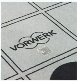
Links: Der im Bodenbelag integrierte RFID-Chip lässt Serviceroboter exakt im Raum navigieren. – Bild: Vorwerk
