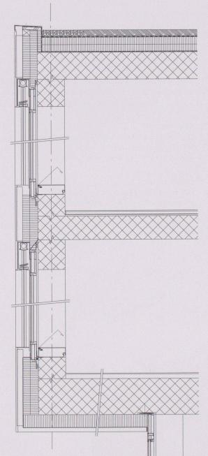
Dachaufbau Dachhaut EP3, EP4 vollflächig verklebt Wärmedämmung PUR papierkaschiert Dampfsperre PDB
