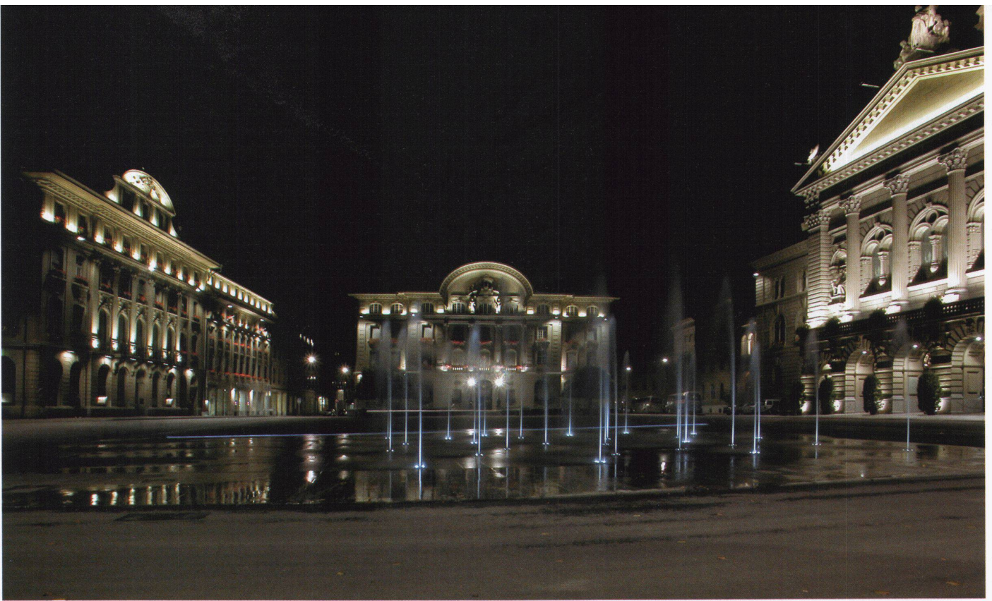
Beleuchtung und Anleuchtung des Bundesplatzes nach der Neugestaltung; dunkle Mitte – helle Randzonen, der Himmel frei sichtbar. – Bild: Nott Caviezel
