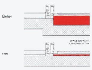
U-Wert 0.20 W/m<sup>2</sup> K Aufbauhöhe 105 mm
