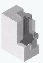
sind beachtlich. «Integra» ist äusserst flexibel positionierbar, die Planung eines separaten Maschinenraumes entfällt. Bei Ersatzanlagen kann der Antrieb auch im bestehenden Maschinenraum über dem Schacht positioniert werden.
