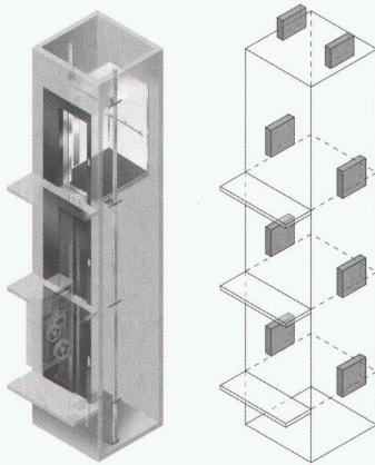
sind beachtlich. «Integra» ist äußerst flexibel positionierbar, die Planung eines separaten Maschinenraumes entfällt. Bei Ersatzanlagen kann der Antrieb auch im bestehenden Maschinenraum über dem Schacht positioniert werden.
