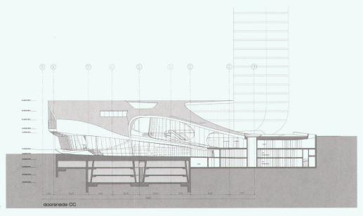
Schnitt durch Tiefgarage und Busbahnhof aus Osten zur Transferhalle
