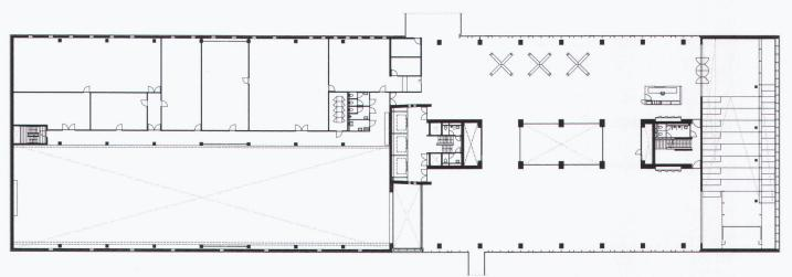
Zugangsgeschoss (1. OG). Links Materialprüfhalle und Werkstätten, in der Mitte die Einganshalle, rechts das als Zugangsrampe ausgebildete Auditorium
