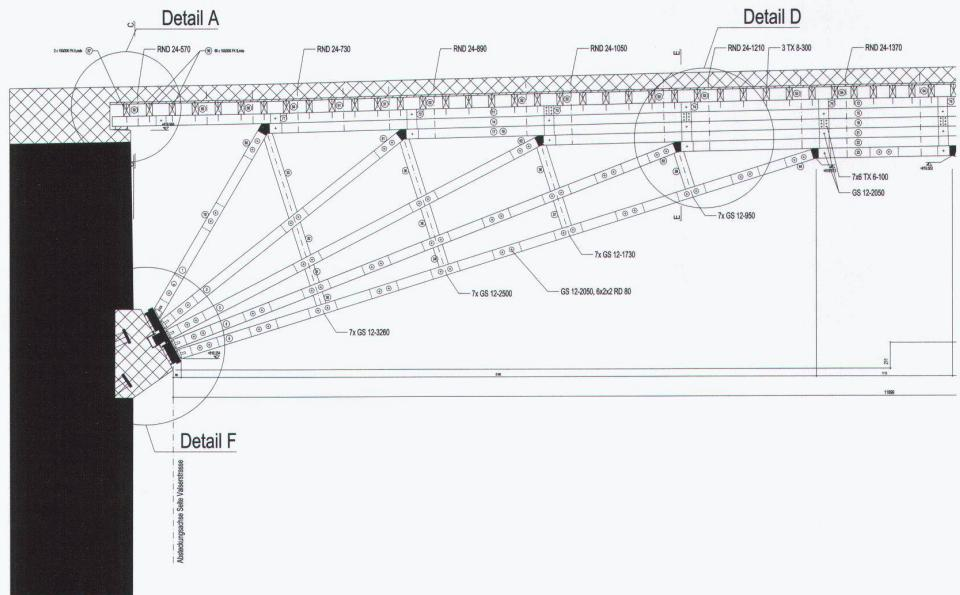
absolute Passgenauigkeit und eine optimale orthogonale Kraftübertragung. Zudem bleiben bei einer allfälligen leichten Verwindung der Stäbe aufgrund des stumpfen Stosses die Kontaktflächen vollumfänglich erhalten. Und nicht zuletzt findet durch das Ausgießen die dem Tragsystem immanente Kontinuität des Kräfteflusses eine Entsprechung: Strebe und Balken werden plastisch zu einer Einheit vergossen.
