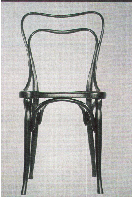
Adolf Loos' Bugholzsessel für das Café Museum in Wien (1899) modifiziert die vorhandene Technologie, indem das kreisrunde Holzprofil durch ein ovales ersetzt ist: Bei nahezu gleicher Biegesteifigkeit ist der Sessel noch leichter. (Dass man einen Kaffeehausessel leicht mit einer Hand bewegen können sollte, ist im heutigen Design völlig vergessen.)
