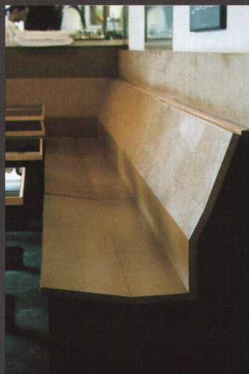
Hermann Czech: Fauteuil aus Holzprofil und Netzbespannung (Swiss Re, Zürich 2000) und Sitzbank aus MDF-Platten (Theatercafé, Wien 1998). Das Sitzprofil auf jeweils eine zeitgenössische Technologie reduziert – der Körper ausschliesslich durch die elastische Netzbespannung oder durch ungepolsterte Platten gestützt Bild (oben): Margherita Spiluttini; Bild (unten): Ronald Mikolics
