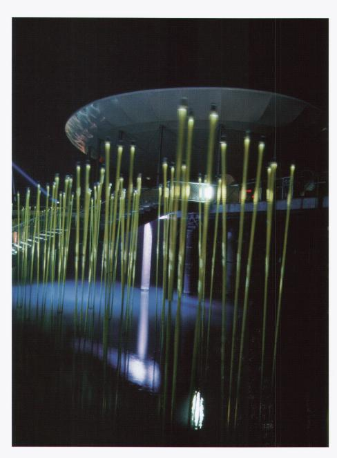
Leuchtende Schilfhalme rings um die Arteplage Neuchätel. An der Spitze des klarsichtigen Kunststoffstabes befindet sich eine grüne Leuchtdiode. Tagsüber speisen Solarzellen den Akku. Beim Eindunkeln aktiviert sich die Elektronik via Solarzelle und die LED beginnt für zirka 2 Stunden zu blinken. Anschliessend folgt für 2 Stunden Dauerlicht bis die LED eine halbe Stunde wieder blinkt, bevor sie erlischt.
