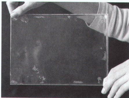
Integration von thermotropen Schichten: Experiment über Streuverhalten unter Wärmeeinfluss
