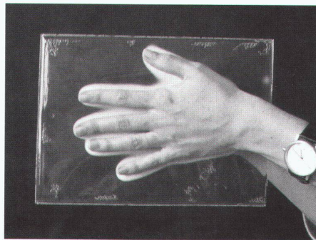
Integration von thermotropen Schichten: Experiment über Streuverhalten unter Wärmeeinfluss
