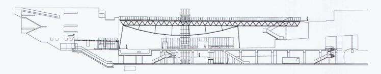
Querschnitt Vallée du Flon mit unterirdischer Bahnhofshalle
