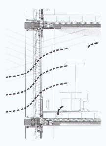
Konstruktionsschnitt Kastenfenster mit energetischem Konzept
