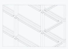
Konstruktive Axonometrien Bandfenster-Fassade
