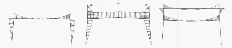
Spannungsverlauf in der Stahl-rahmenkonstruktion (Portal-träger): bestehender Zustand; neue Vorspannung durch da-rüber liegende Deckenkonstruk-tion; momentenfreie Stütze dank der darüber liegenden Tragkonstruktion.
