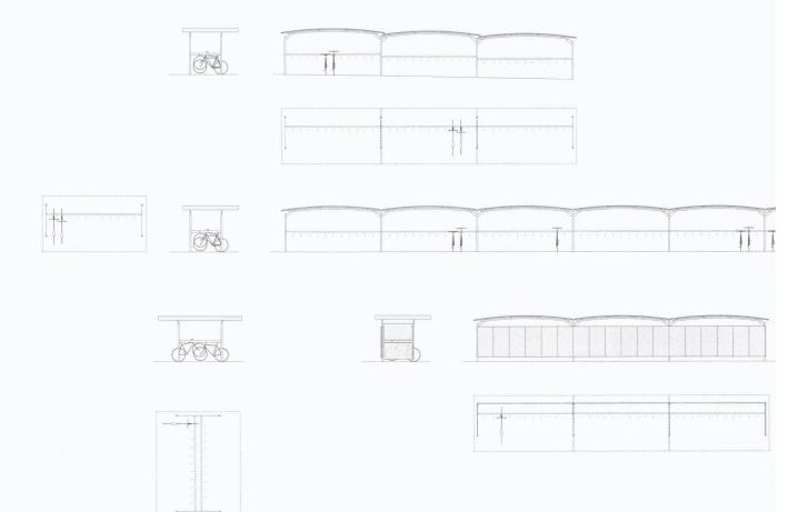
Übersicht BWA-Bausystem mit verschiede-nen Varianten für Aufstellung und Ausbau: Anlage bei grösserem Gefälle mit Versätzen im Dach (oben), Anlage einseitig (Mitte), Anlage doppelseitig (unten links), Anlage mit Wänden aus Lochblech, Holzlamellen für Pflanzen oder Faserzement als leichte Paravents (unten rechts).
