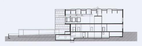
Querschnitt durch Schreinerwerkstatt/Anlieferung ▷ Coupe trans-versale sur l'atelier de menuiserie/ livraison ▷ Cross section through the carpentry workshop/delivery area
