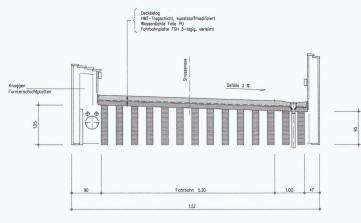
Querschnitt durch Binderschar
