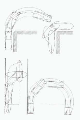
Vergleich Platzbedarf bei engen Kurven: «Dymaxion Car» und herkömmlicher Wagen. D Compa raison du rayon de courbe minimum «Dymaxion Car» et voiture classique D Comparison of space require ents in narrow curves: the "Dymaxion Car" and a conventional Zeitgenössische Werbung der «The
