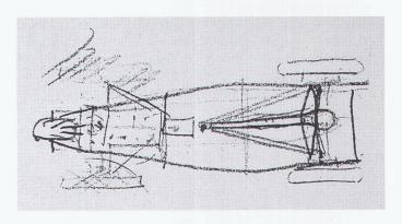
Skizze eines Chassis mit modifizierter Achsanordnung, Vorderachse durchgestrichen, an ihrer Stelle Einzelrad. D Esquisse d'un châssis à système d'axes modifié. Axe avant supprimé et rem placé par une roue unique.
