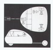
Projekt «D-45» eines Kleinwagens mit variablem Radstand für Henry Kaiser. Variante mit Zwilingsbereifung, 1943. ▷ Projet «D-45» d'une petite voiture à empattement variable pour Henry Kaiser. Variante à pneus jumelés, 1943.
