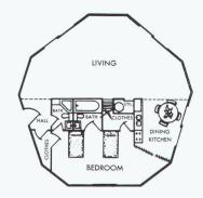
Der Entwurf für den Dymaxion Bathroom zeugt vom Vertrauen, das Fuller in integrierbare Teile setzt, die rasch in Neubauten oder bestehende Behausungen eingebaut werden können. Da Service-Einheiten leicht zu transportieren sind, können sie jeweils anderswo wieder verwertet werden.
