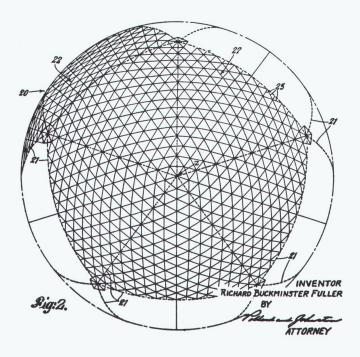
Geodätische Kuppel D Coupole géodésique D Geodesic dome
