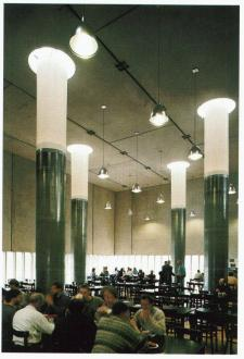
Um die Speicherkapazität des Betons nicht zu beeinträchtigen, wurde auch im Restaurant auf eine abgehängte Decke verzichtet. Die Frischluftzufuhr erfolgt statt dessen über zehn Säulen aus Lochblech und Milchglas, die zugleich als Oblichter diffuses Tageslicht spenden. Eine grosse, rote Bank dient als Lüftungskörper. Wandbekleidungen aus rotem Stoff und aus Kuhfellen erzeugen eine im Vergleich zur grossen Halle weichere Raumakustik.
