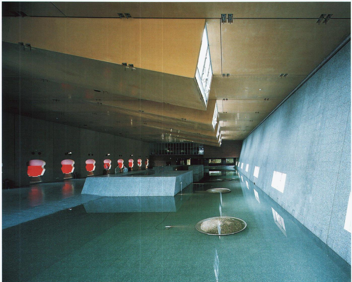
Regenwasser wird auf dem Dach gefiltert und rinnt über enorme Speier in die zentrale Halle. Dort wird es in einem 180 000 Liter fassenden Becken gesammelt. Muscheln, die in fünf schwimmenden Schalen leben, entkräften das Wasser auf natürliche Weise.
