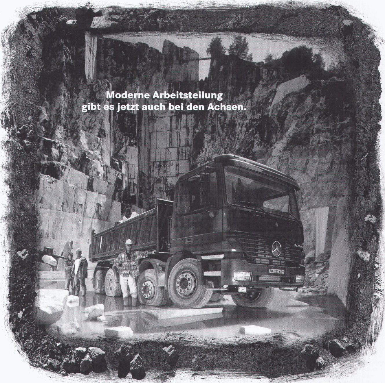
«Einer trage des anderen Last» – das gilt jetzt auch für Achsen. Bei jeder Bodenwelle und bei jedem Hindernis, das überfahren wird, bekommt normalerweise immer nur eine Achse die volle Wucht des Stosses ab. Anders beim weltweit ersten Achslastausgleich für Vierachser: Er verteilt die Last gleichmässig auf beide Vorderachsen und baut so Belastungsspitzen ab. Diese moderne Art der Arbeitsteilung schont Material,
