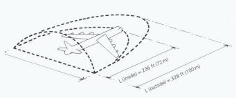
Geometrie Die Gebäudehülle, die die Form der B52 und der anderen Ausstellungs-objekte umfasst, wurde von einer einfachen geometrischen Form, der Ringfläche (Torus), abgeleitet.
