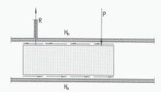
Punktuell gestützte Wandscheibe als unverrückbares Tragelement. Die drehende Wirkung der gegeneinander versetzten Belastung P und der Auflagerreaktion R wird durch das in den Decken erzeugte Dabei spielt es keine Rolle, ob die Wandscheibe auf einem tiefer-liegenden Teil aufliegt, an eine weitere Scheibe desselben Geschosses seitlich anschliesst oder an einem darüberliegenden Bauteil aufgehängt ist. (Abb. 2)
