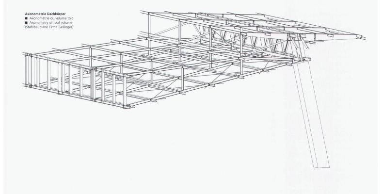
Träger war es möglich, Rasterabweichungen zwischen den neuen und den bestehenden Dächern sinnvoll und konstruktiv einfach aufzunehmen.
