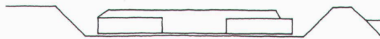
Bau einer Verankerung: der Senkkasten wird in einem Trockendock gegossen. ■ Construction d'un ancrage: le caisson est bétonné dans un bassin de radoub. ■ Construction of anchor block: the caisson is cast in a dry dock.
