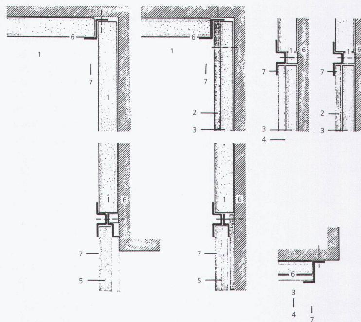
Detail der vorgefertigten Innenvände aus Spanplatten, die mit Messingwinkelprofilen verbunden sind:
