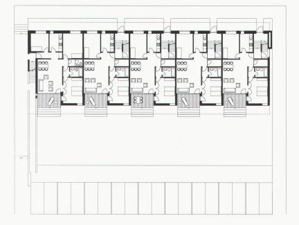
werden Räume in Schnitt und Grundriss so ineinandergeschachtelt, dass sich ohne Verlust an Geschossflächen Raumüberhöhungen realisieren lassen. Maximale räumliche Ausdehnung wird durch Diagonalbezüge, fliessende Übergänge und durchgehende Wohnräume geschaffen. Verschiedene Rundwege innerhalb der Wohnung machen die Grundrisse grosszügig und offen
