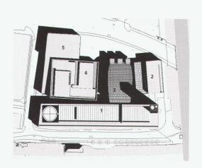
Heizkraftwerk Mitte, Salzburg 1 HKW Heizkraftwerk, 2 BGH Betriebsgebäude – Heizkraftwerke, 3 REA Rauchgasreinigungsanlage, 4 BGE Betriebsgebäude – Elektrizitätswerke, 5 UW Umspannwerk
