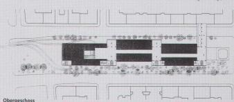
schnitt der U6 schwebendes, als Brückenbauwerk konzipiertes, gläsernes Gebäude, 180 m lang, 27 m breit, mit einer Nutzfläche von 3000 m<sup>2</sup>. Es liegt nicht symmetrisch im Strassenraum des Gürtels, sondern sucht als mäanderförmiges Geschossband die Innen- und Aussenseite des Gürtels räumlich zu differenzieren.
